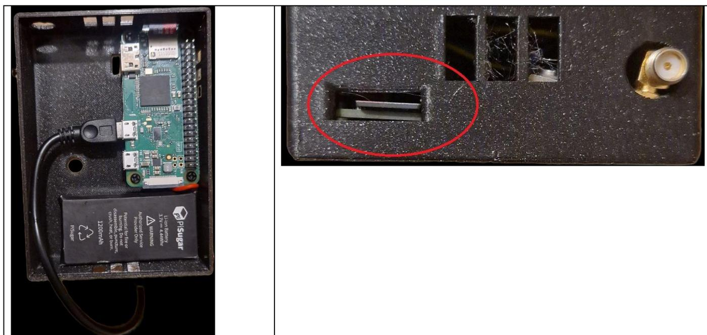
**8.2** Connectez le câble miscoUSB au Arduino Micro. Et insérez le tout délicatement dans le boîtier, l'entrée male du câble GPS doit ressortir par le trou prévu à cet effet.
