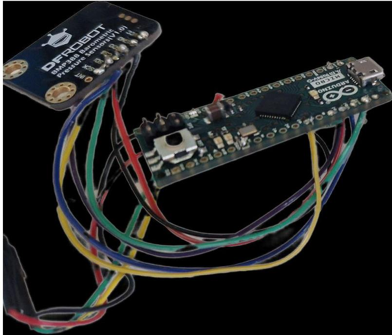
**5. Couper les pins du haut du Arduino Micro afin de gagner de la place dans le boîtier**
